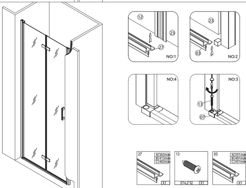
NO:1 – Placez le joint de vitrage (15) entre les vitres et le joint magnétique (24) sur la vitre de la porte (23).
