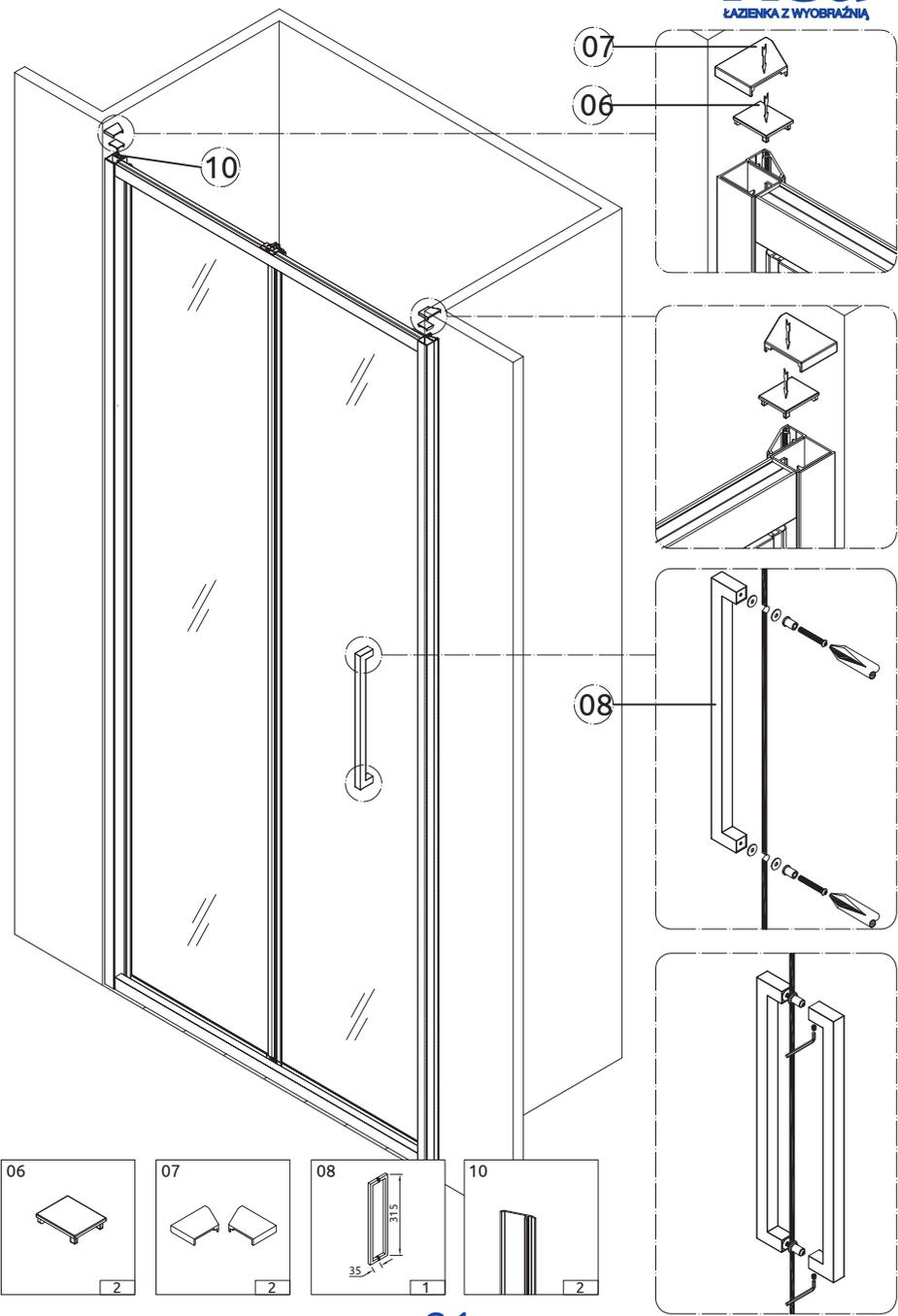
Insérez les capuchons (06,07) dans les profils verticaux.
