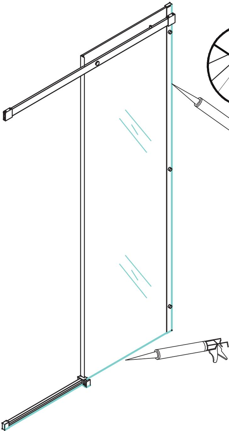
Fixez tous les joints inamovibles avec du silicone sanitaire et laissez sécher pendant 24 heures.
