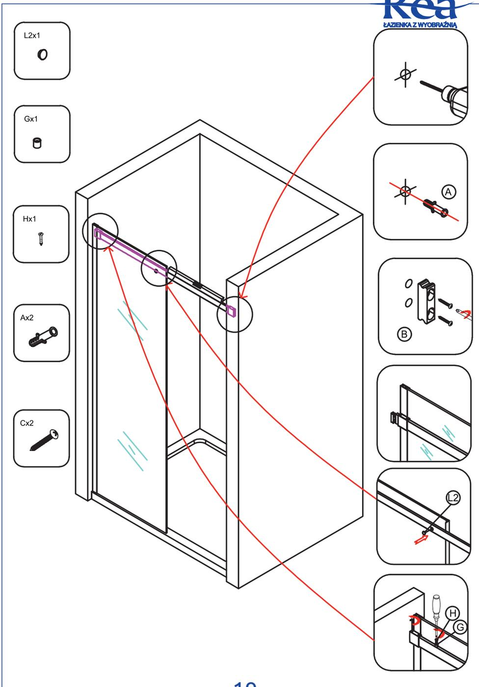
Percez les trous pour le deuxième élément (B) et placez-y les boulons (A).
